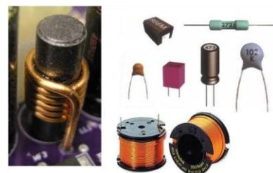
Индуктивность катушки:  $L = \mu\mu_0 \frac{N^2 S}{\ell}$ . Возникновение ЭДС самоиндукции при размыкании электрической цепи. Направление индукционного тока (демонстрация). При размыкании электрической цепи ток продолжает течь (индукционный ток), а поэтому между разомкнутыми клеммами ключа
