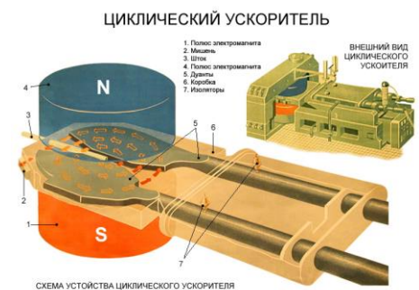
СХЕМА УСТРОЙСТВА ЦИКЛОТРОНА
